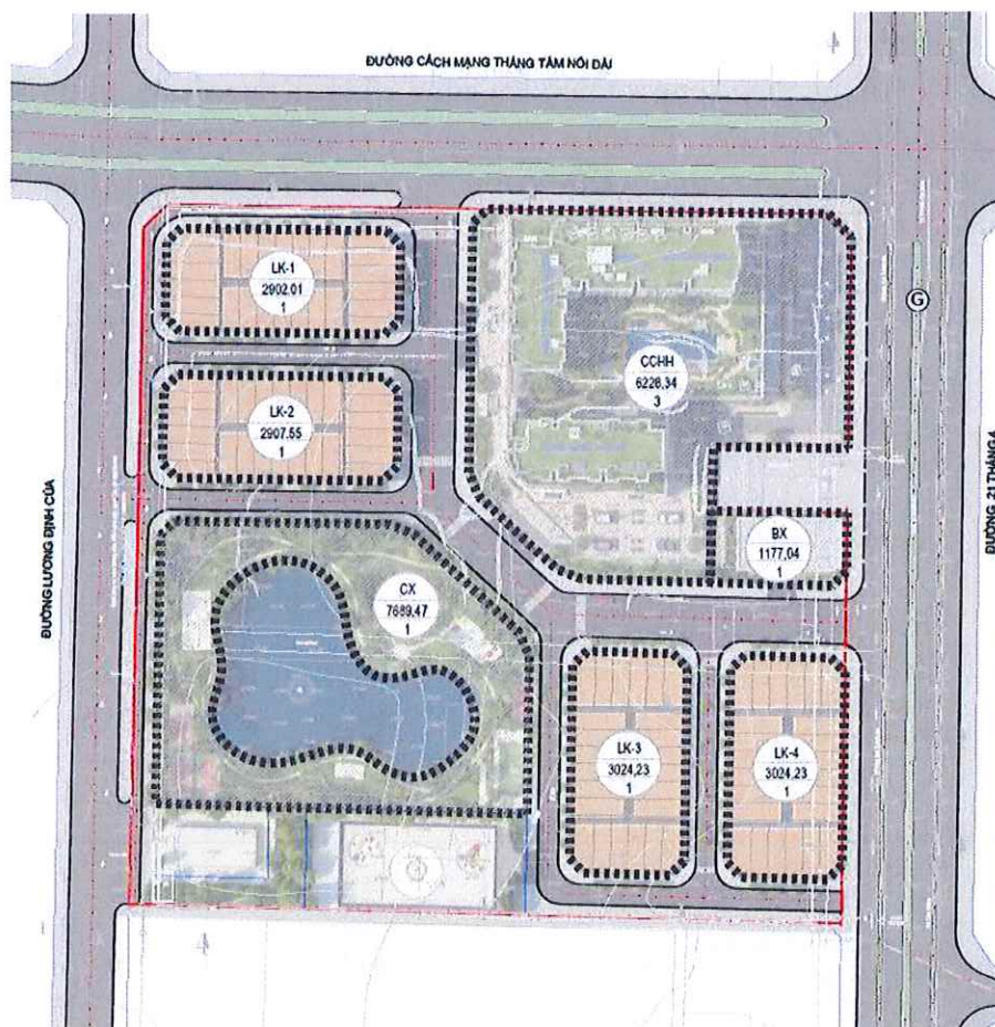
Hình 31 - Bản vẽ xác định các khu vực xây dựng công trình ngầm.
